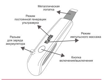
Портативный ультразвуковой аппарат «D&D» MX-N57 состоит из электронного блока с встроенным ультразвуковым преобразователем (щупом) в виде металлической лопаточки трапециевидной формы. Работа осуществляется в непрерывном или импульсном режимах.
